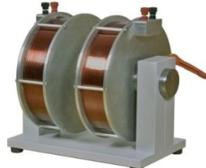
شكل ( ) يوضح المغناطيس الكهربائي المختبري والذي يولد مجال مغناطيسي بقدرة 2 طن وبتيار 20 امبير
