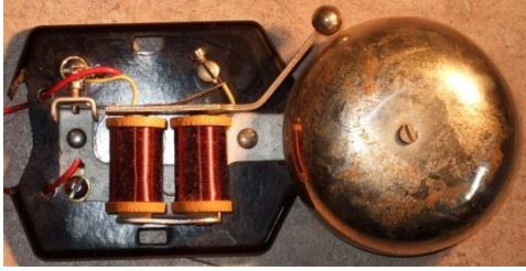
شكل ( ) المغناطيس الكهربائي في الجرس
