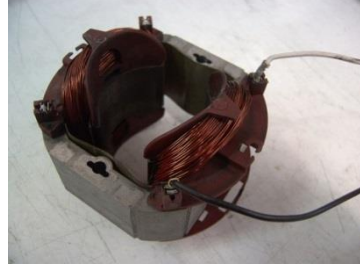
شكل ( ) يوضح مغناطيس التيار المتردد على الجزء الثابت للمحرك الكهربائي
