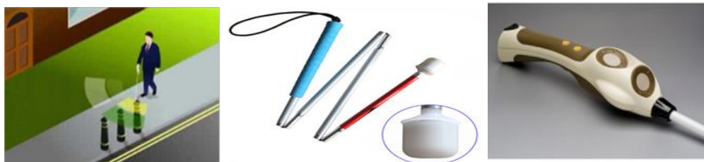
شكل ( ) توظيف عصا ذكية للمكفوفين مستلهمة من الامواج فوق الصوتية التي يصدرها الخفاش
