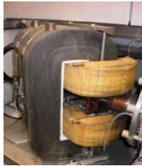
شكل ( ) يوضح المغناطيس الكهربائي في مطياف الكتلة
