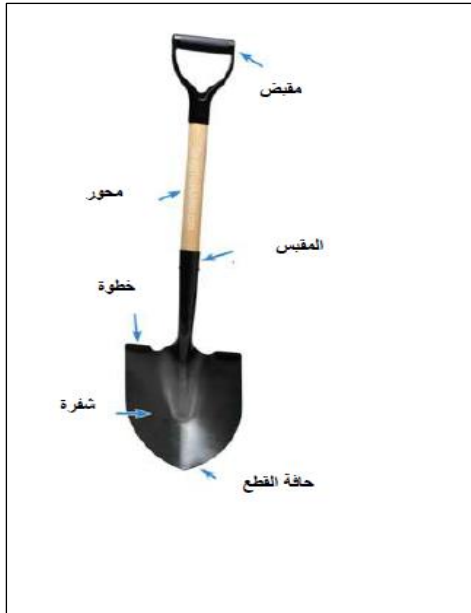
شكل(10) أجزاء المجرفة الأساسية (tools)
