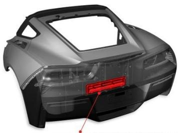
أصبحت شفروليه كورفيت 2014 أول سيارة تدمج مشغلات سبائك الذاكرة الشكلية، والتي حلت محل المحركات الثقيلة لفتح وإغلاق فتحة التهوية التي تطلق الهواء من الصندوق، مما يسهل الإغلاق. إذ ان السيارة الرياضية من الجيل السابع المعاد تصميمها هي أول مركبة تستخدم سلكًا خفيف الوزن مصنوعًا من سبائك الذاكرة طورته شركة جنرال موتورز بدلاً من مشغل
