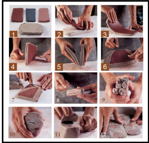
شكل (3) طريقة الدمج اليدوي لتقنية الترخيم https://ceramicartsnetwork.org/daily/article/How-to-Create-Agateware-Pottery-Using-Colored-Clays-and-a-Plaster-Press-Mold
