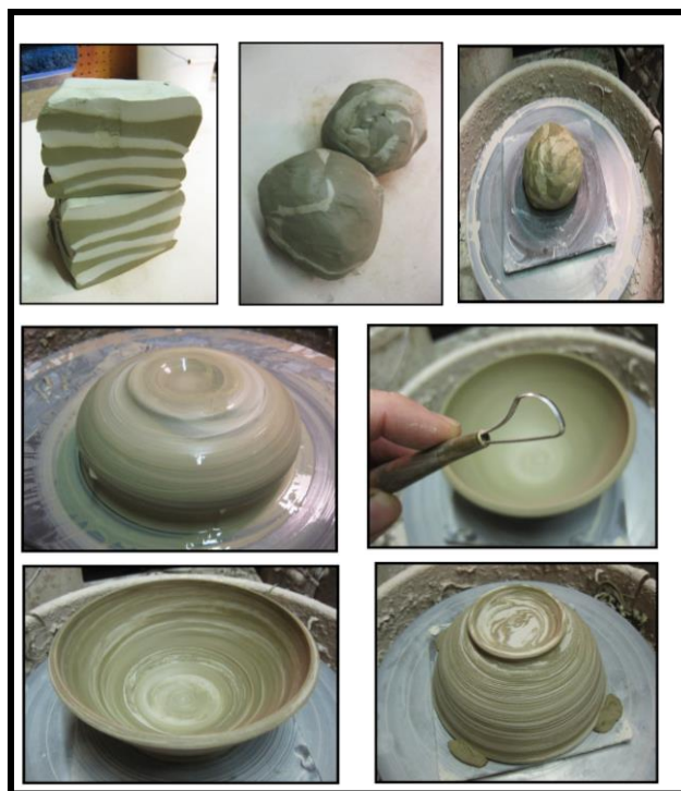
شكل (4) طريقة الدمج بعجلة الخزاف (الدولاب) لتقنية الترخيم http://firewhenreadypottery.com/2014/03/marbled-clay
