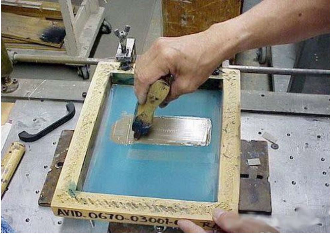
خطوات الطباعة وتثبيت الإطار على منضدة الطباعة
